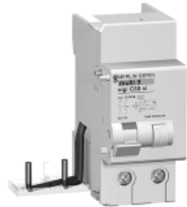
Fig. 41: Ejemplo de DDR de tipo A adaptable a un interruptor automático BT (Bloque Vigí C60-300 mA - Merlin Gerin).
